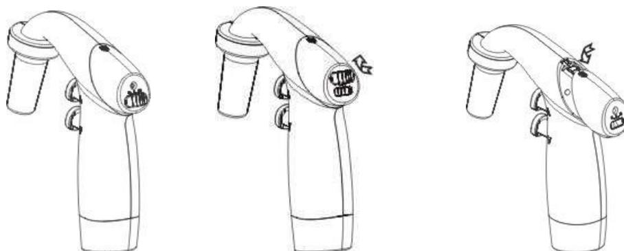
Retirez maintenant le couvercle du compartiment des piles en appuyant sur la flèche en relief et en le faisant glisser en même temps vers l'arrière. Retirez les piles. Insérez de nouvelles piles et inversez la procédure ci-dessus. Remplacez le compartiment des piles et remettez le couvercle des piles à sa place.
