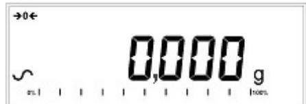
Una señal estable ~ aparece cuando el analizador se estabiliza. Desaparecerá si el analizador no esta estabilizado. El cero exacto es obtenido cuando el símbolo " $\rightarrow 0 \leftarrow$ " aparece en a la izquierda del display
