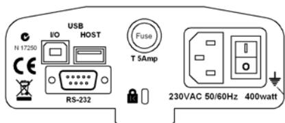
l'interruttore principale **on (aperto) / off (chiuso)** è posizionato sul retro. Per attivare l'unità, premere l'interruttore on/off sul retro dell'analizzatore, il display mostra il numero di serie e revisione del software prima di iniziare la sua sequenza automatica di controllo. Il display visualizzerà peso zero accompagnato dal simbolo  $\rightarrow 0 \leftarrow$ . Un pulsante di accensione sul pannello anteriore spegne lo schermo e imposta l'analizzatore in modalità di riposo.
