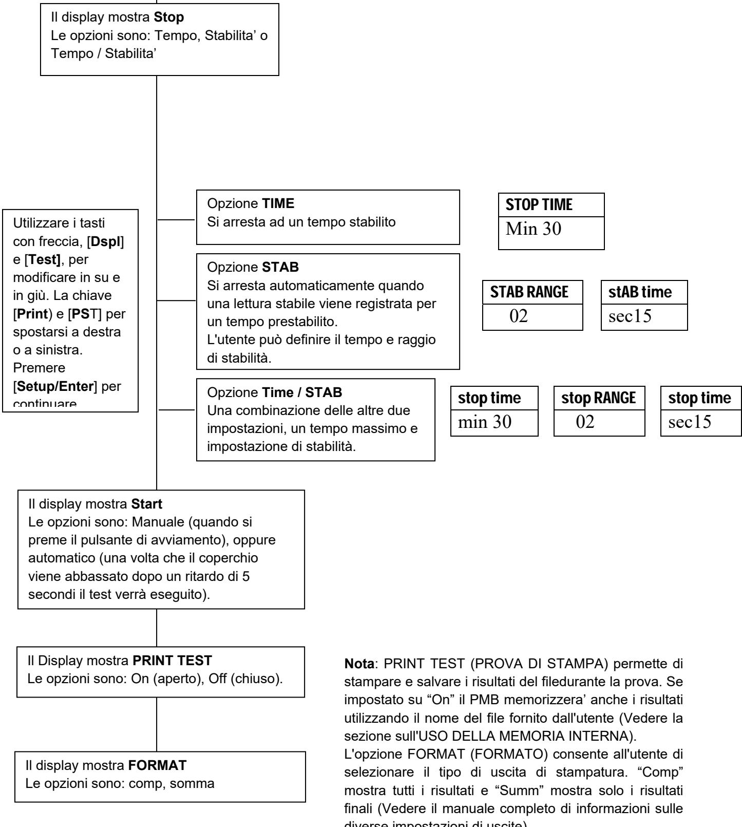
L'utente può stampare la configurazione corrente premendo il tasto **[Print]** durante il processo purché la seconda funzione per il tasto non sia necessaria.
