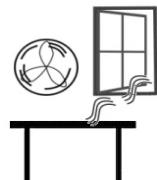
Ne pas placer près de fenêtres ouvertes, de bouches d'air conditionnées ou de ventilateurs qui pourraient causer un courant d'air et des lectures instables.
