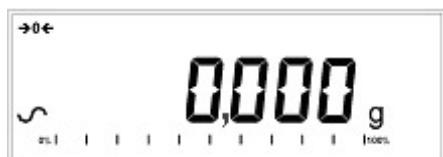
È buona norma lasciare l'analizzatore raggiungere una temperatura interna stabile prima dell'uso - normalmente 30 - 60 min tempo di riscaldamento è consigliabile. Un segno di stabilità ~ viene visualizzato quando l'analizzatore è in condizione stabile. Si spegnerà se l'analizzatore non è stabile. Lo zero esatto è mostrato quando il simbolo " $\rightarrow 0 \leftarrow$ " è al lato sinistro del display.
