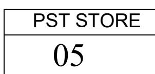
Appuyez sur **[Setup/Enter]** pour sélectionner le numéro PST. Si la mémoire PST a déjà un test sauvegardé, l'analyseur demandera si le test peut être écrasé. Pour continuer, appuyez sur **[Setup/Enter]** pour écraser l'ancien test et sauvegardez le nouveau.
