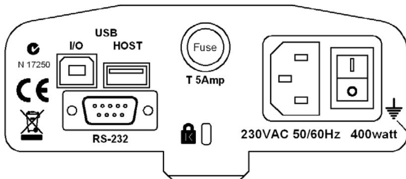
Le panneau arrière dispose de connecteurs pour l'interface de données, le porte fusible, le point d'attache antivol et l'alimentation d'entrée.
